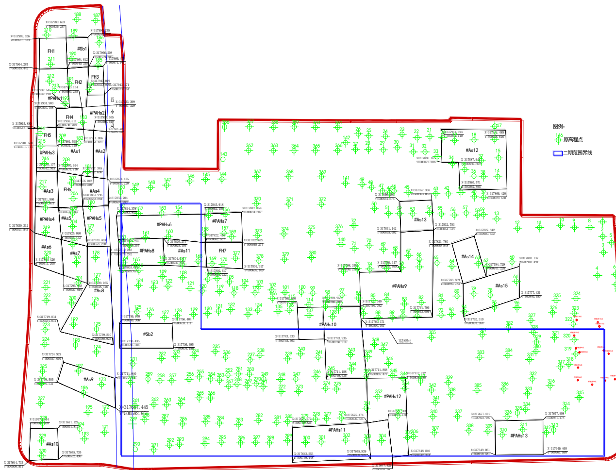
图 1.1 绍兴恒大珺睿府污染土壤清挖平面图
