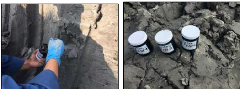
图 4-4 基坑取样检测
